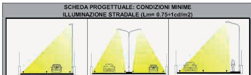
Figura 54 - Esempio di schema progettuale per condizioni minime per strade ME4a, ME4b
