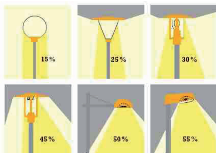
Figura 51 - Percentuale di illuminazione utile
