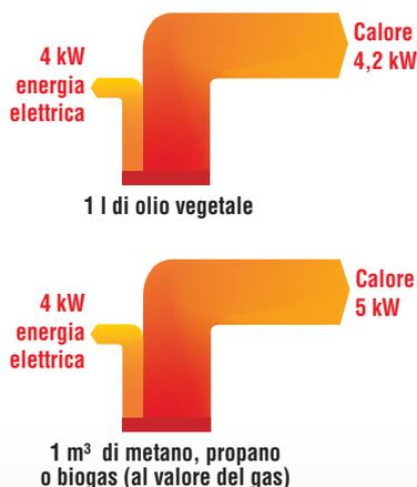
I nostri impianti di cogenerazione funzionano a scelta con **diesel, biodiesel, olio vegetale, metano, propano o biogas** e si contraddistinguono per la lunga durata e l'elevata efficacia: con 1 litro di olio vegetale possono essere prodotti 4 kWh di corrente elettrica e 4,2 kWh di calore!
